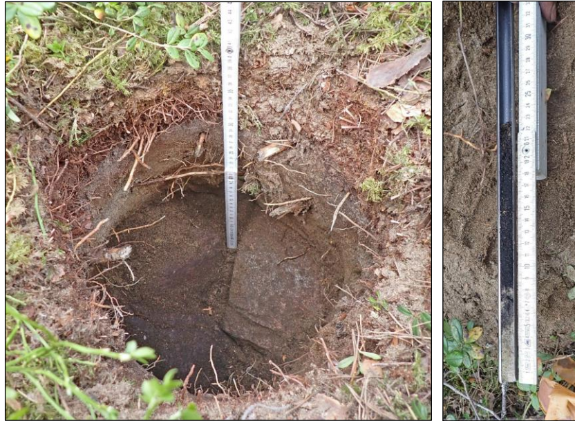
Vasemmalla: Hiilihautaan kaivetussa koekuopassa löydetyt kivet. Oikealla: Koekuopan pohjalle, kivien väliin tehty maakairanpiston maaprofiili kairapesässä.
